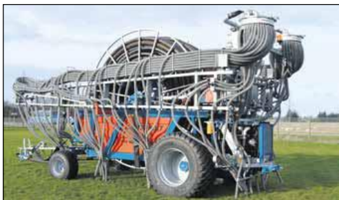
Til at udlægge kartoffelvand har Andels-Kartoffelmøllefabrikken i Brande har investeret i ny FASTERHOLT FM4800H vandingsmaskine monteret med 675 meter 110 millimeter slange.
